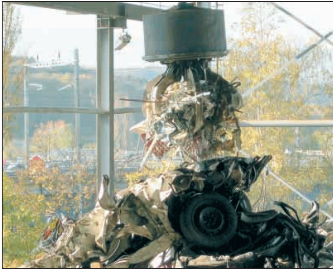
Le broyeur traite 600 tonnes à l'heure. EWI
